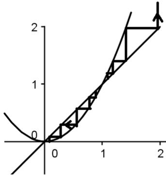
Figura 1.7: O ponto 0 é um ponto fixo atrator para  $F(x) = x^2$ , enquanto que o 1 é um ponto fixo repulsor.
