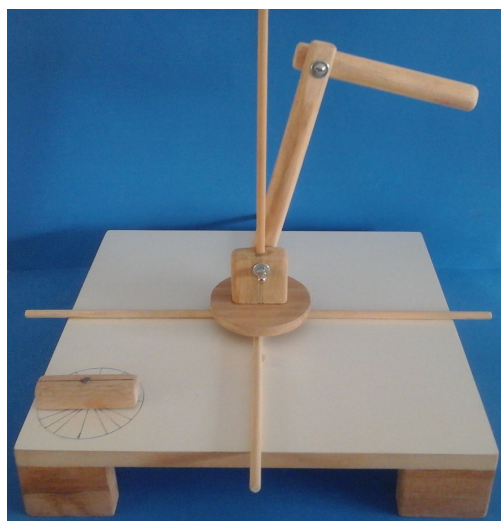
Figura 46: Protótipo de um braço robótico com três graus de liberdade
